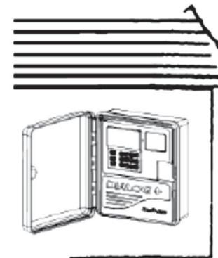
Расположите контроллер вблизи источника питания 230 В, 50 герц. Контроллер должен быть подсоединен к источнику электропитания, который соответствует стандартам и защищен предохранителями на электрической панели. Выбирайте место расположения в укрытии, чтобы на прибор не попадала вода.
